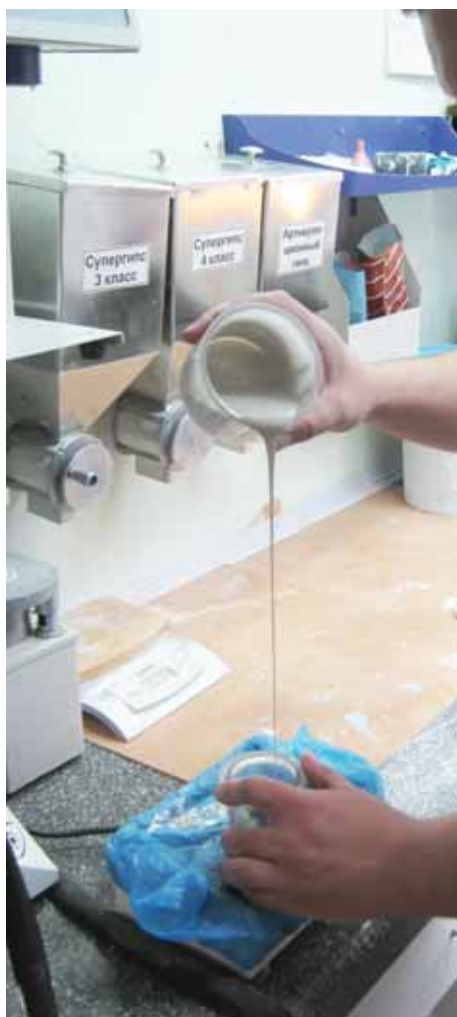
Заливку производим тоненькой струйкой на высокой частоте и с низкой амплитудой
