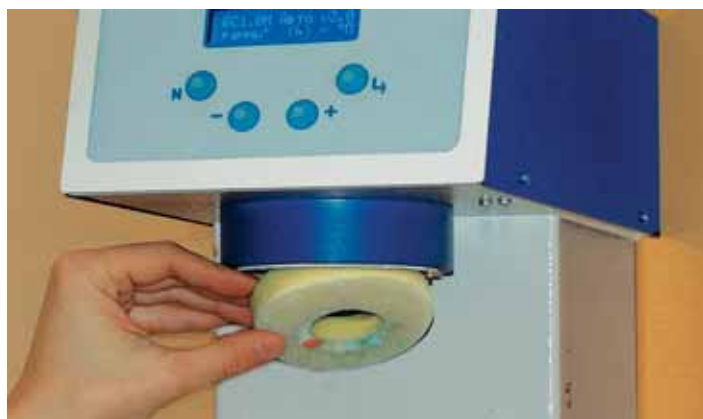
Губчатый фильтр предотвращает попадание смеси в насос
