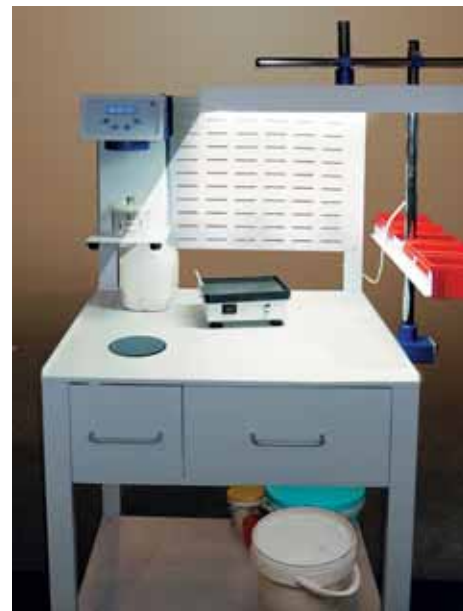
Гипсовочный стол СУЛ 9.0 ГИПС. Перфорация на задней стенке СУЛ 9.0 предназначена для навешивания любого оборудования и полезных элементов: бункеров, вакуумсмесителя, полок, электроблоков и т.п.
