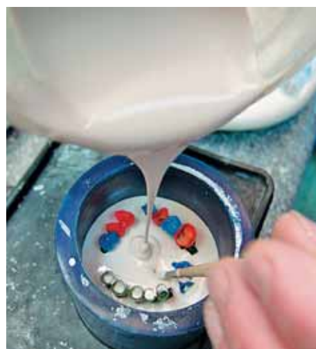
Как только масса полностью закрывает конструкцию, выключаем вибростол
