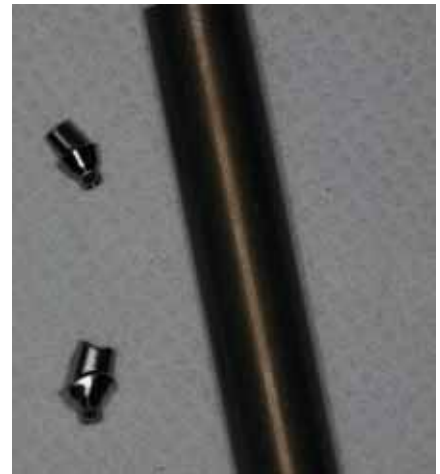
Рис. 1. Титановый пруток и изготовленные из него абатменты
